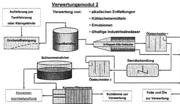
Die separierten Öle und Fette werden einer thermischen Verwertung zugeführt
