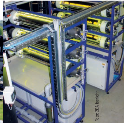
Außen- und Innenansicht der im Juni 2009 in Betrieb genommenen Anlage. Mit UV-Licht lassen sich problematische Inhaltsstoffe behandeln
